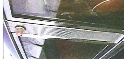
Entre les deux portières, le montant est recouvert d'un enjoliveur gaufré et il incorpore un feu de position.
